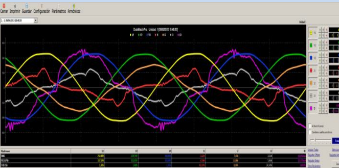
• Módulo osciloscopio de 7 canales. Con autoescala y funciones.
